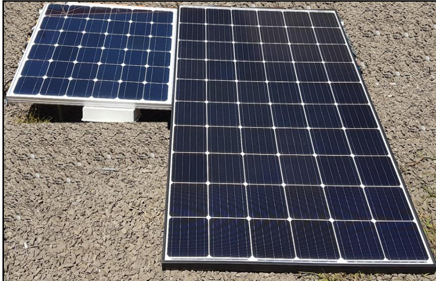
Figura 11 – Módulo solar desenvolvido neste projeto (à esquerda) e módulo comercial (à direita) para testes comparativo de desempenho
